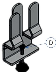
Presser l'embout de compression [D] sur la tête de la vis de fixation [C], jusqu'à l'enclencher.
