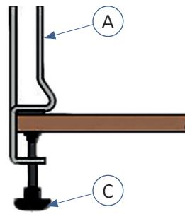
Mettre en place la Pince soni fix clamp [A] sur la bordure de la table puis visser la vis de réglage [C] pour la fixer.
